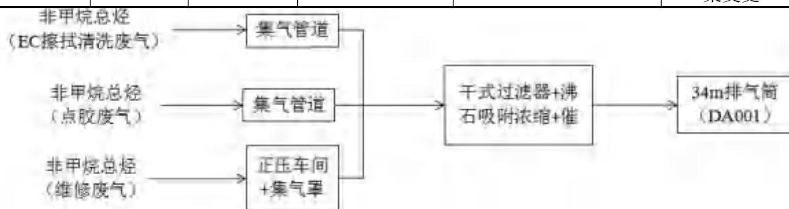
图 4-1 项目废气处理工艺流程图
